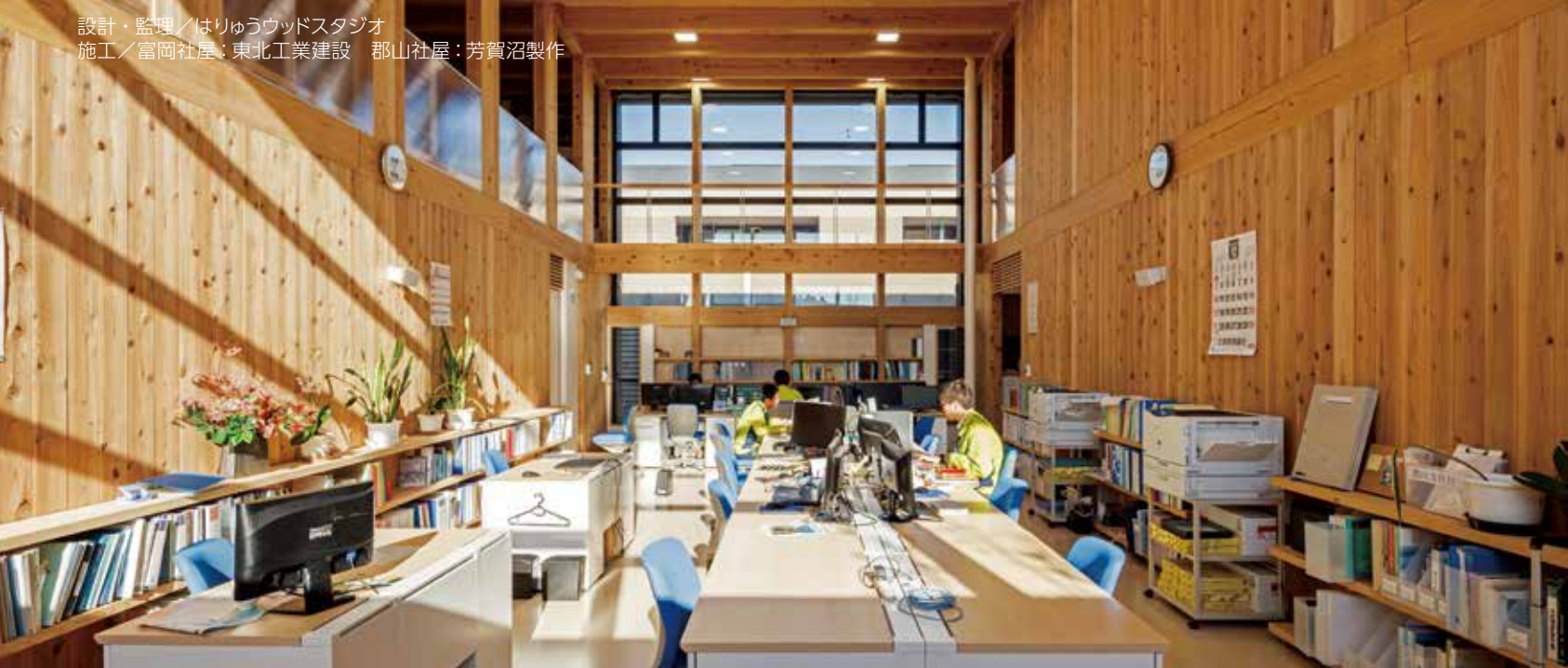
富岡社屋執務室内観 高さ2.85mの縦ログパネルを2層分立ち上げ、約6.1mの吹抜けを構成している。縦ログ材・梁・桁材には富岡の森で産出したスギ材が使用されている
