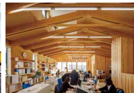
郡山社屋内観 富岡の森から切り出したモミ材を組み合わせて8mスパンの調弦梁による一室空間の執務室が生まれた
